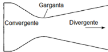
Figura 1. Representação de um bocal convergente-divergente (Sutton e Biblarz, 2001)
